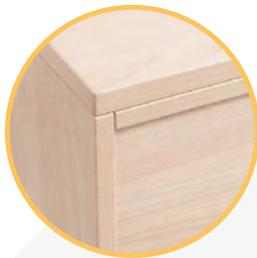
Die 10 mm starken **Rückwände** sind eingenetet und verleimt. Die **Korpuskanten** sind mit ABS-Umleimer verschlossen, Ecken und Kanten gerundet. Die **19 mm starken Seitenwände** sind durchgehend und mit Ober- und Unterboden und Sockel fest verdübelt und verleimt.
