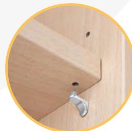
**Einlegeböden:** verstellbar im Rasterabstand von 32 mm auf Metallträgern mit Auszugssicherung. Vorderseite mit ABS-Kante. Bis zu einer Schrankbreite von 80 cm beträgt die Bodstärke 19 mm, ab 80 cm Schrankbreite beträgt sie 25 mm.
